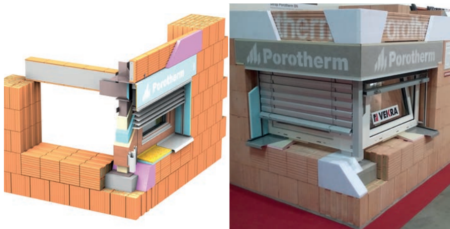
Řešení rohového okna pomocí ocelového sloupku a překladů KP Vario UNI R
